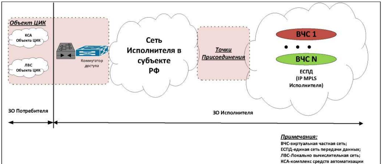
Рис.2. Архитектура Компонента «Предоставление доступа» для Объектов ЦИК.
